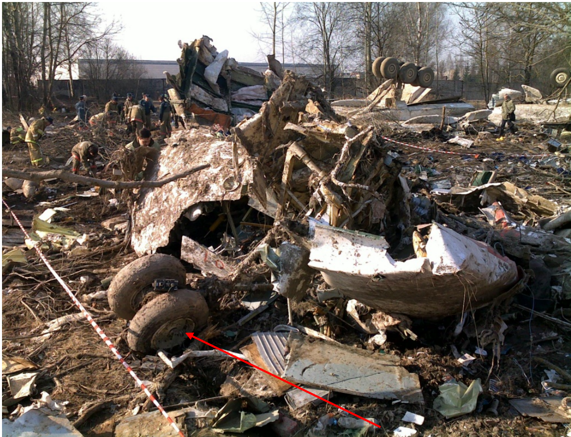
Rys. 11. Wypuszczona przednia goleń podwozia
