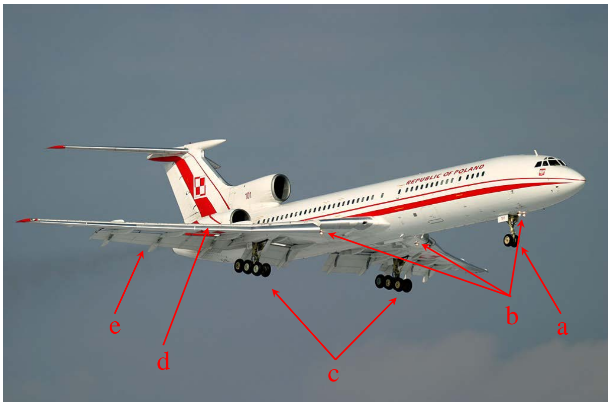
Rys. 5. Widok samolotu Tu-154M nr 101 w konfiguracji do lądowania. Świadczą o tym wypuszczone:
