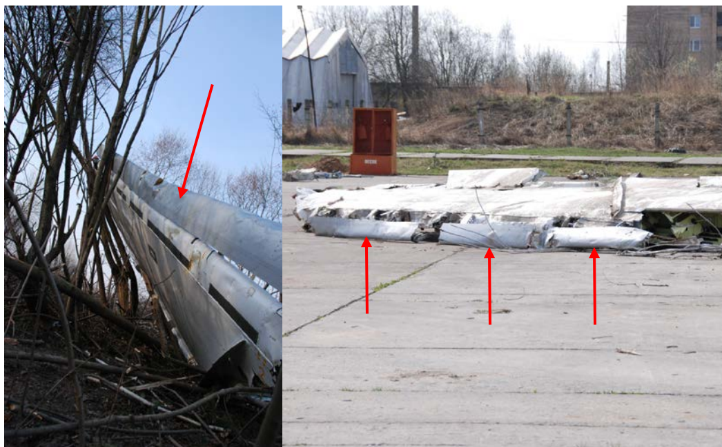
Rys. 7. Wypuszczone sloty lewego i prawego skrzydła samolotu
