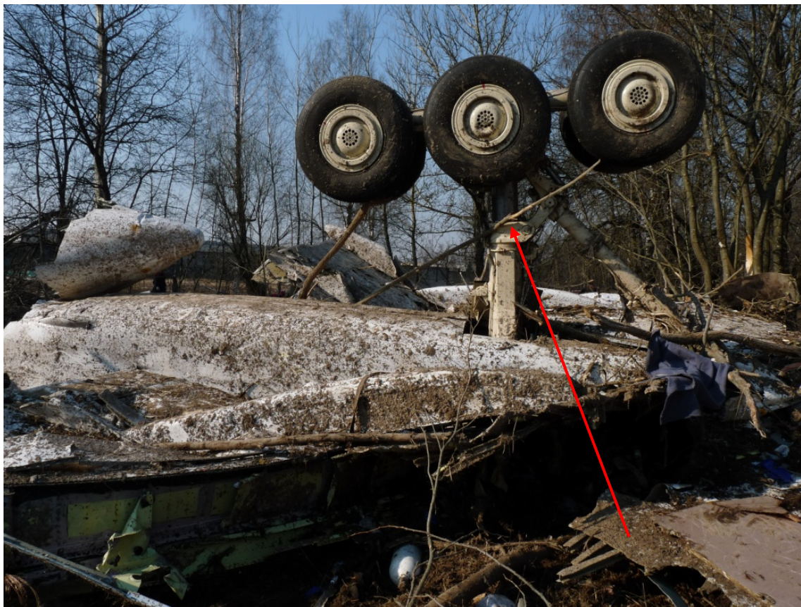
Rys. 12. Wypuszczona prawa goleń podwozia głównego
