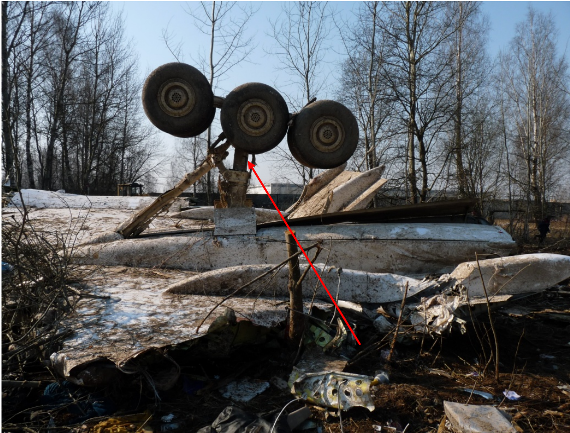
Rys. 12. Wypuszczona prawa goleń podwozia głównego
