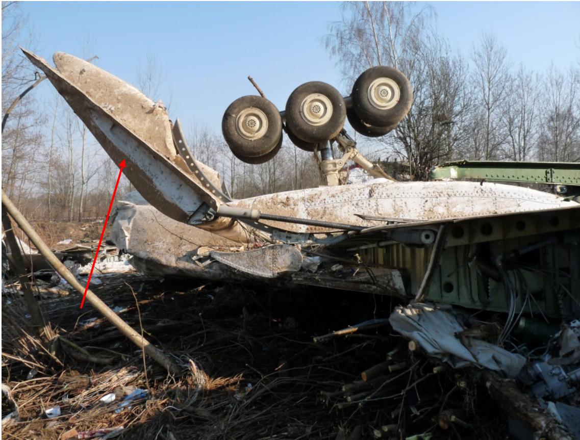
Rys. 8. Wychylone klapy zaskrzydłowe
