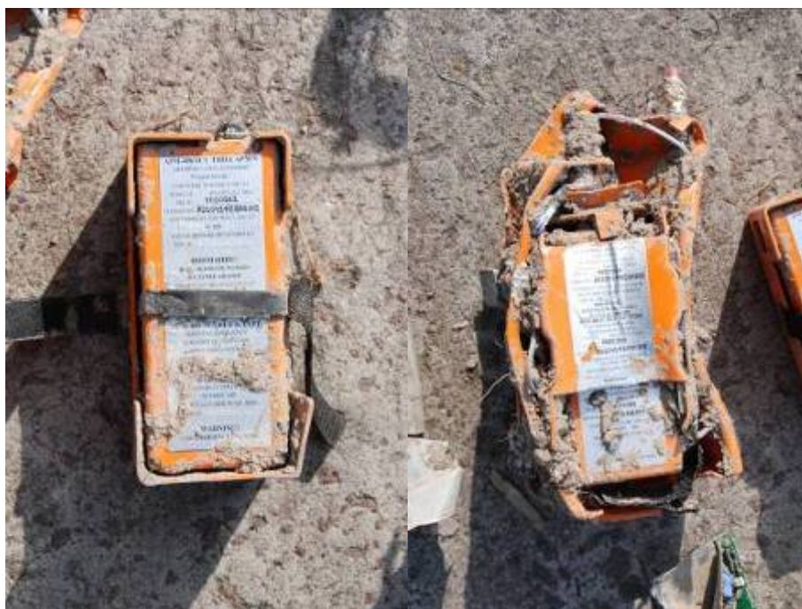
Rys. 36. Radiostacje awaryjne typu ARM-406AC1 (z lewej) i ARM-406P (z prawej)
