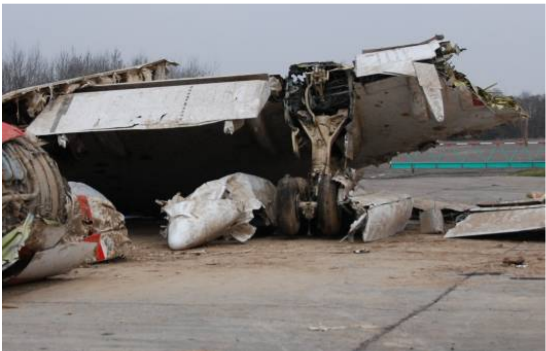
Rys. 15. Krawędź spływu prawego skrzydła oraz prawe podwozie główne
