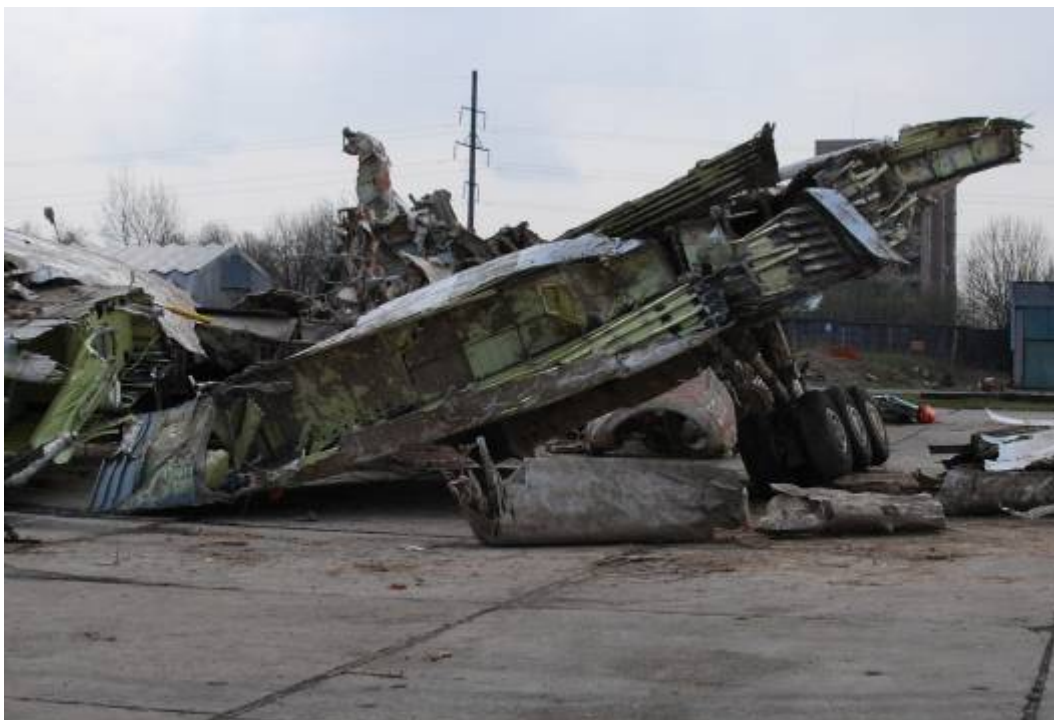
Rys. 16. Rozerwana krawędź natarcia lewego skrzydła
