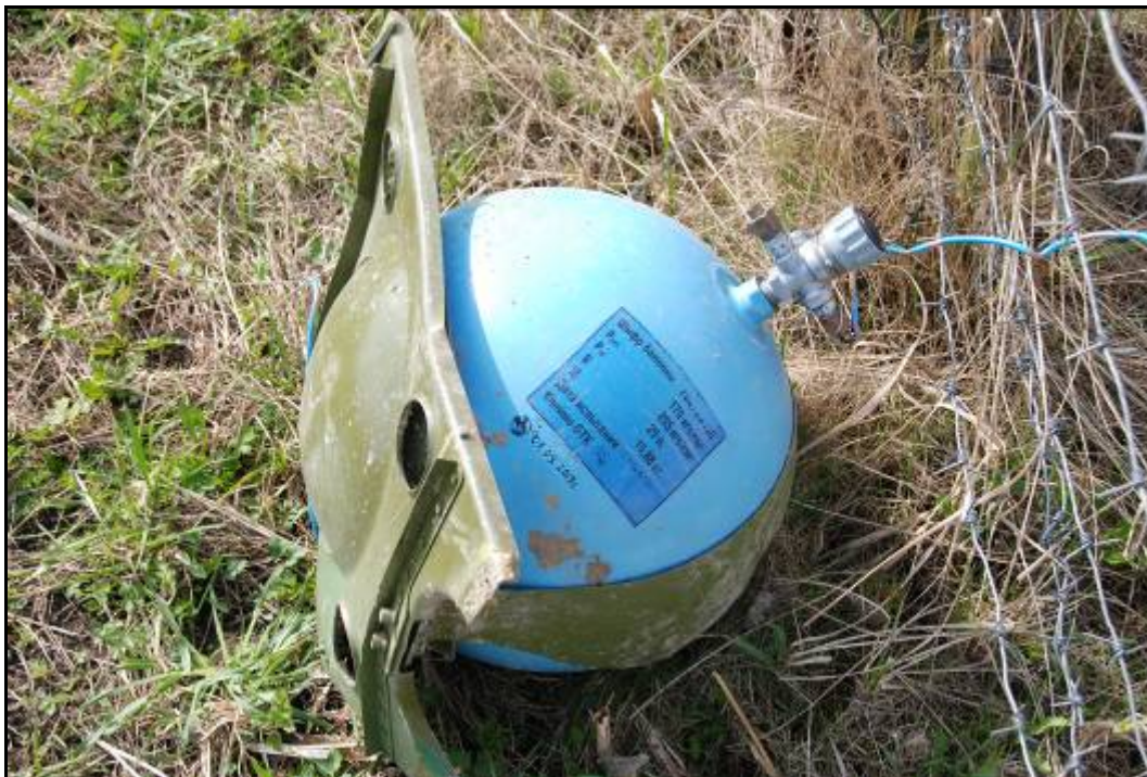
Rys. 32. Butla УБIII-25/150M wraz z częścią podstawy i przewodami tlenowymi
