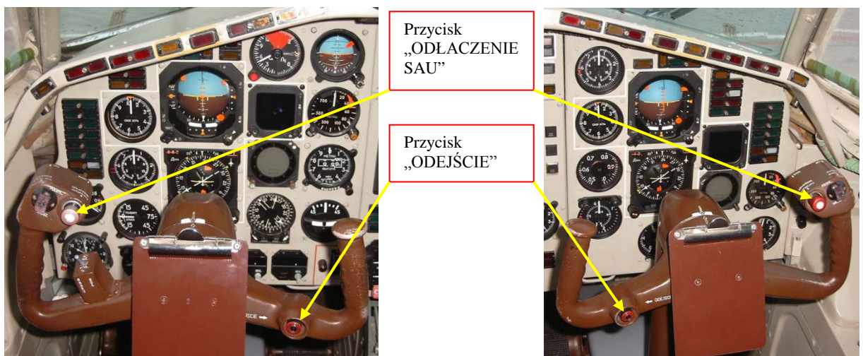
Rys. 18. Rozmieszczenie przycisków sterowania SAU na wolantach.
