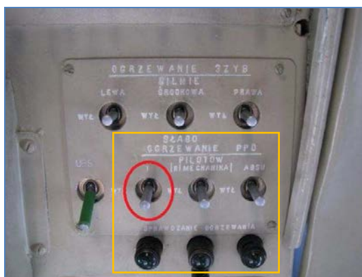
Rys. 28 Panel sterowania włączeniem i sprawdzaniem układu ogrzewania PPD
