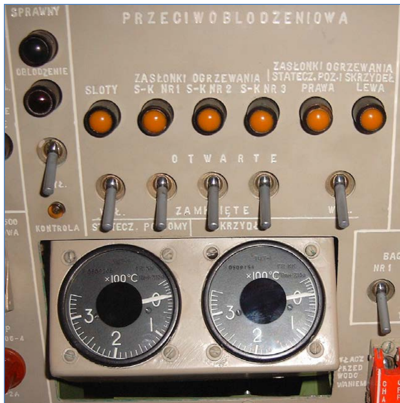
Rys. 29 Panel sterowania instalacją przeciwołódzeniową samolotu Tu-154M.
