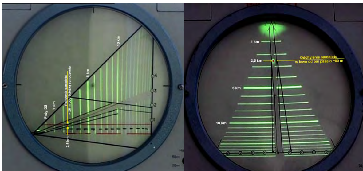
Fot. 7. Zobrazowanie pozycji samolotu względem ścieżki schodzenia i osi DS na wskaźnikach WISP-75
