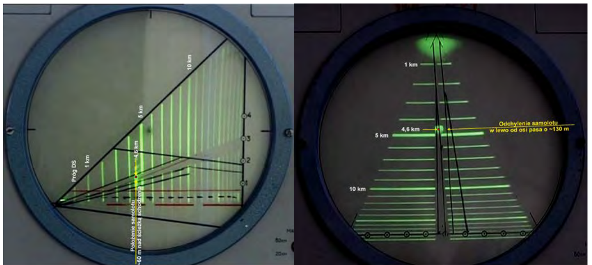
Fot. 5. Zobrazowanie pozycji samolotu względem ścieżki schodzenia i osi DS 26 na wskaźnikach WISP-75
